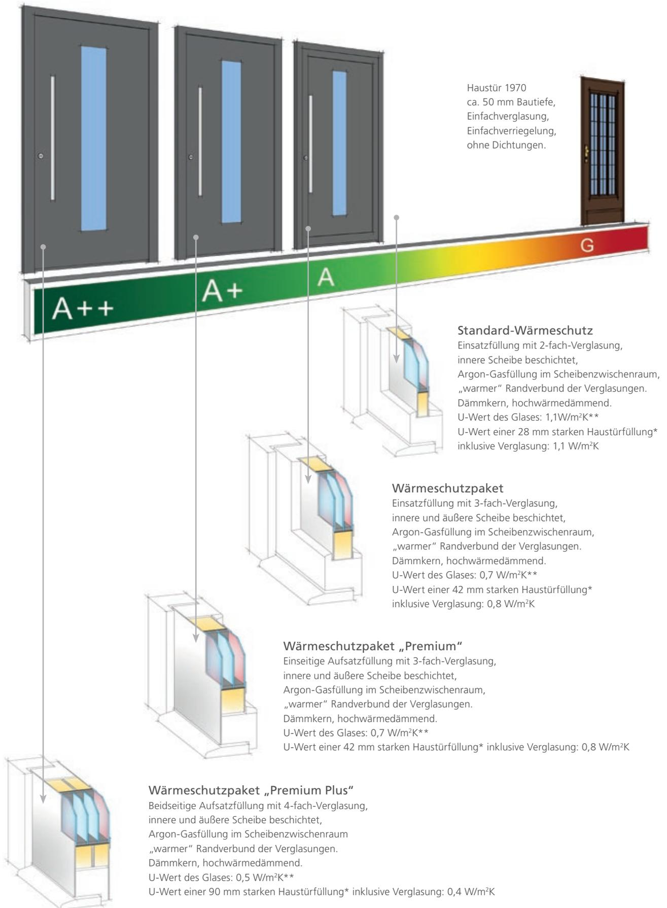
\* Alle Berechnungen auf Basis des Füllungsmodells 6508, bei einer Abmessung von 1000 x 2000 mm.
